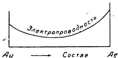
Фиг. 9. Кривая электропроводности непрерывного ряда твердых растворов.
